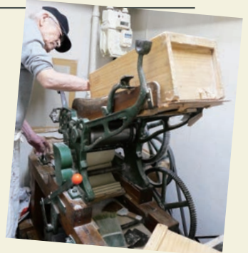
1979年の創業以来、働き続けている製麺機。これ一台で粉の攪拌から製麺までをおこなえる
