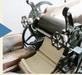
攪拌した粉をセットすると、平状の生地が出てくる
